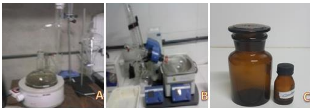
Figura 3. Processo de extração de óleo essencial de Croton pulegiodorus (Euphorbiaceae) no aparelho Clevenger (A); purificação do óleo em Evaporador Rotativo (B); armazenamento em potes de cor âmbar (C).
