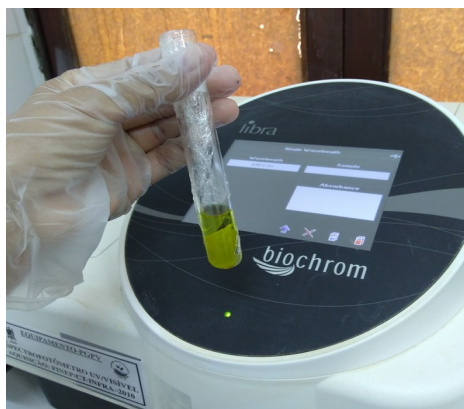
Figura 7. Determinação do teor de clorofilas ( Chl a , Chl b e Chl total ), realizada com o auxílio de espectrofotômetro (biochrom) nas absorvâncias de 645, 652 e 663 nm.
