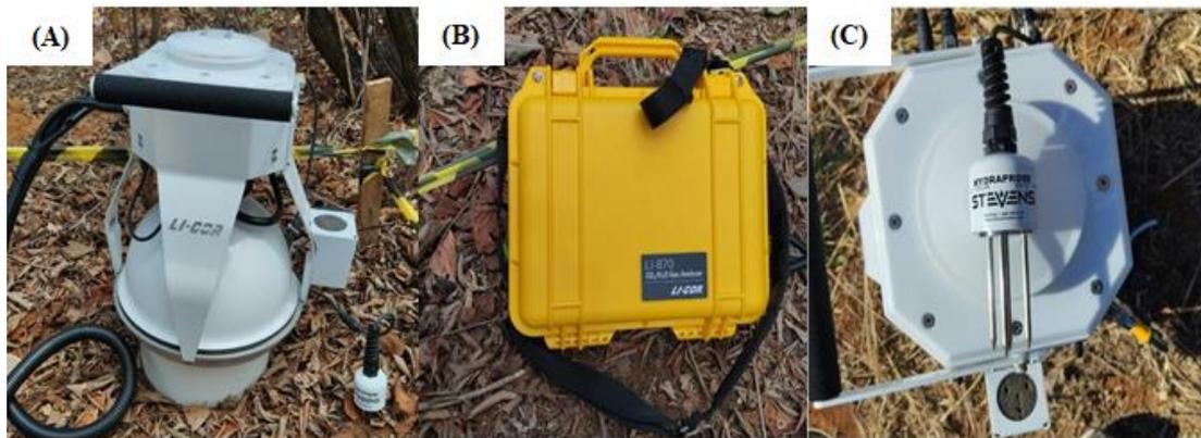
**Figura 6.** Analisador de gás infravermelho- LI-870 CO<sub>2</sub>/H<sub>2</sub>O Gas Analyzer (IRGA). Smart Chamber do IRGA que realiza o processo de medição do efluxo de CO<sub>2</sub> do solo (A); Multiplexador, se mostrando como fonte de energia para o funcionamento da Smart Chamber (B); Sensor Stevens HydraProbes, responsável pelas medidas de temperatura e umidade (C). **Fonte:** A autora, 2023.
