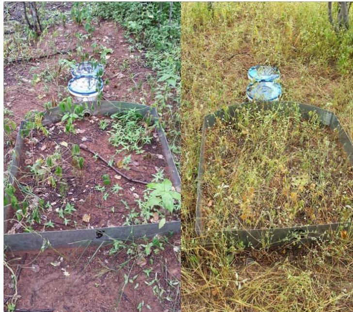
**Figura 7.** Calha de monitoramento do escoamento superficial. Souza et al. (2015)
