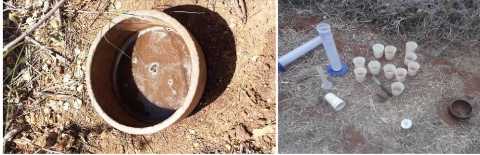
**Figura 6.** Ensaio de infiltração com infiltrômetro de anel simples com (D =150 mm)
