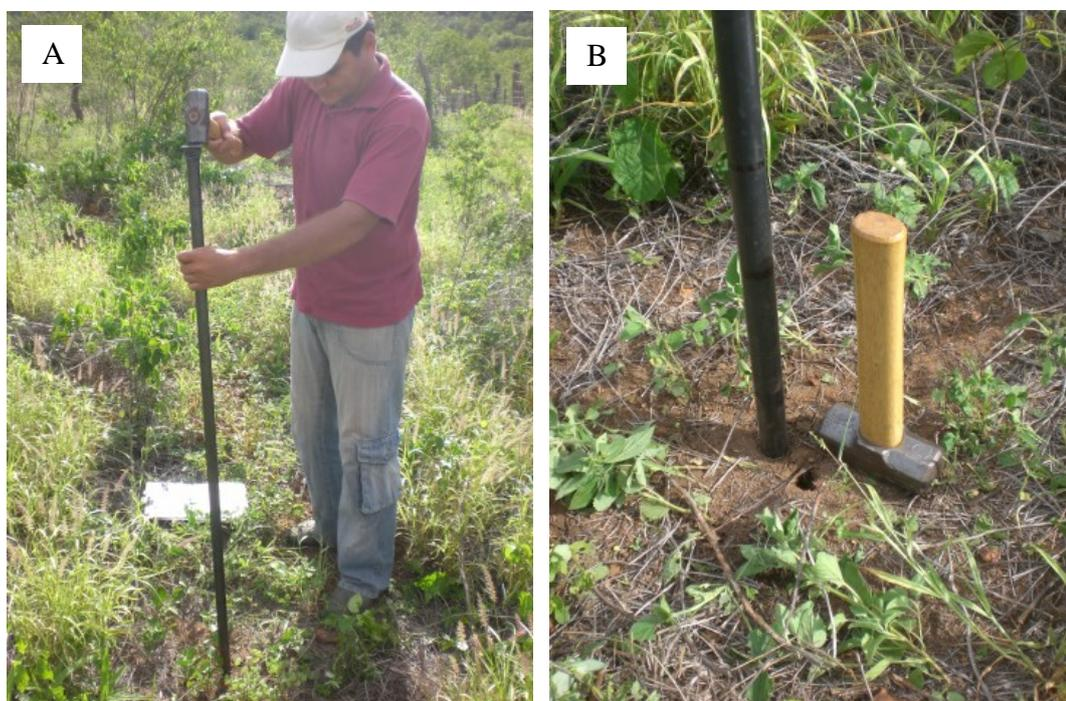
Figura 5. Haste metálica utilizada para coleta do solo (A) e detalhe da haste graduada de acordo com as profundidades de solo avaliadas (B).
